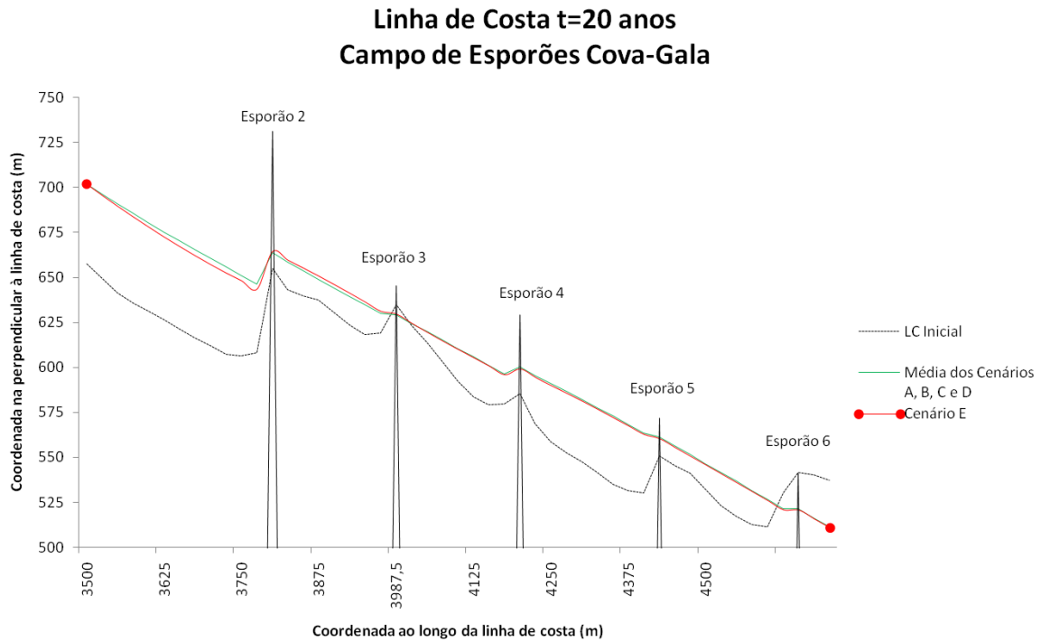
Figura 5.15 - Comparação da linha de costa simulada após 20 anos de simulação entre a média dos cenários A, B, C, D, o cenário E e a linha de costa inicial, na zona do campo de esporões Cova-Gala
