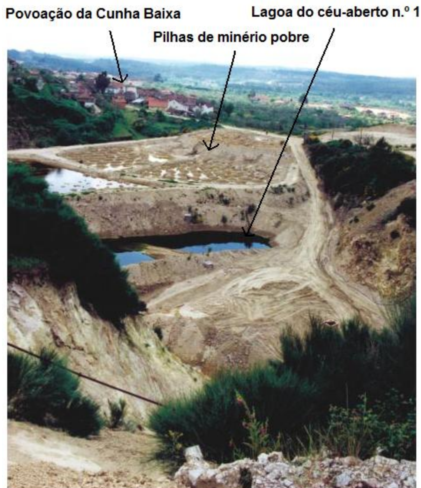
Figura 3 – Vista geral da área do céu-aberto n.º 1, onde ocorreu a lixiviação do minério pobre (fotografia de 1990, gentilmente cedida ENU (Neves, 2002)).
