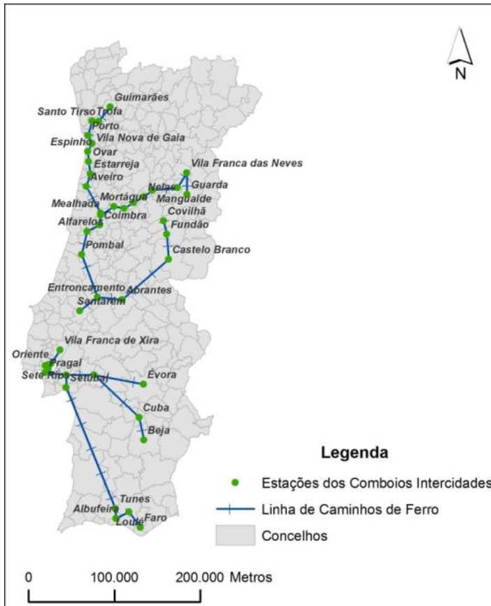
Figura 20: Esquema de Portugal Continental com estações dos comboios intercitys, do exemplo para o algoritmo 2-centro absoluto, já com obtenção de dois sub-grafos
