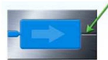
Figura 3.6 – Rasgo para escape de gases. (Fonte: ©Autodesk, 2010)
