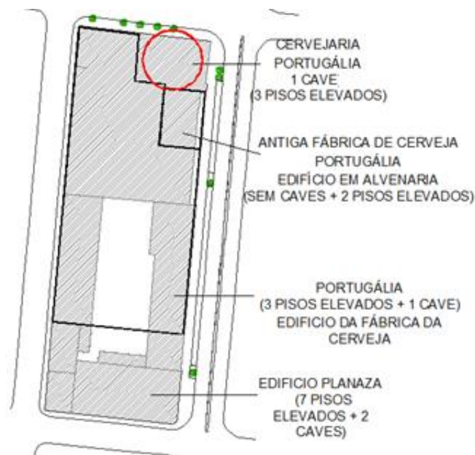
FIGURA 105. REPRESENTAÇÃO ESQUEMÁTICA DAS CONFRONTAÇÕES DO LOTE A INTERVENCIÓNAR, ADAPTADO DE [46].
