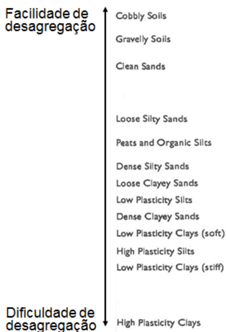
FIGURA 81. FACILIDADE DE DESAGREGAÇÃO DOS DIFERENTES TIPOS DE SOLO, ADAPTADO DE [18].
