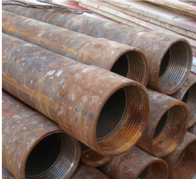
FIGURA 65. UNIÕES EXTERIORES DE MICROESTACAS [5].
