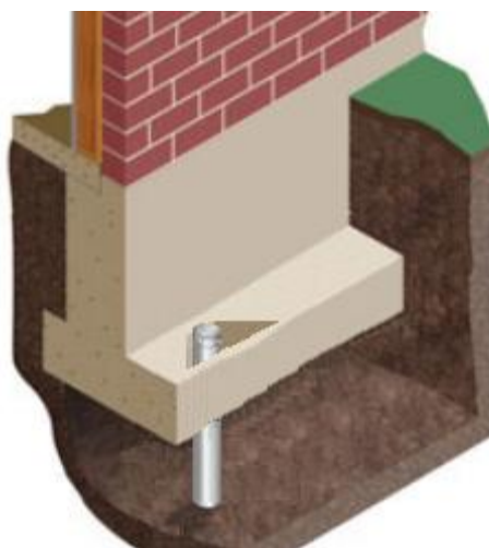
FIGURA 71. ESQUEMA DE MICROESTACA SELADA DIRECTAMENTE À SAPATA EXISTENTE, ADAPTADO DE [34].
