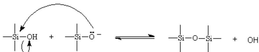
Figura 12 – Ataque nucleófilo na formação da ligação em ponte Si-O-Si [17].
