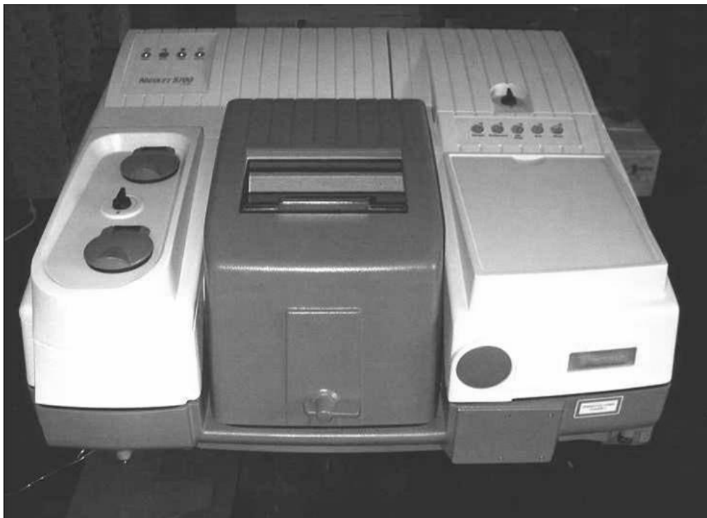
Figura 23 – Espectrómetro de Infra-Vermelho de Transformada de Fourier, Nicolet 5700 FTIR [33].
