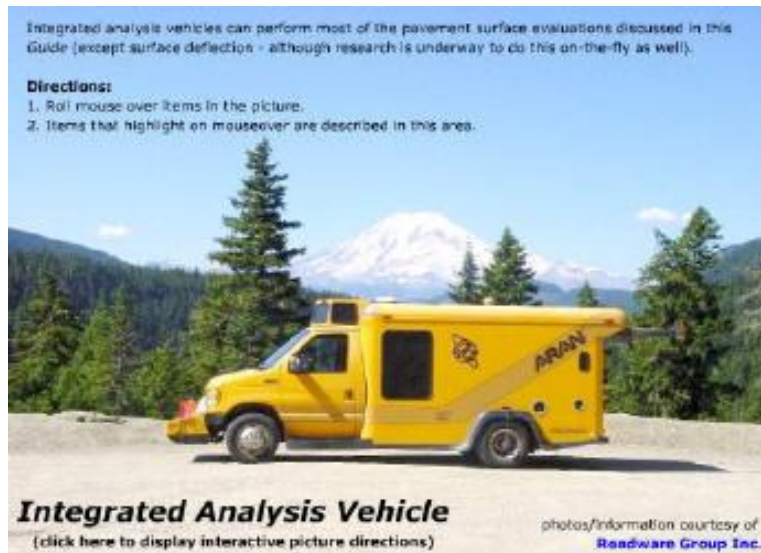
Figura 2.4 Veículo instrumentado para múltiplas análises da superfície de pavimentos, extraída de (WSDOT, 2009)
