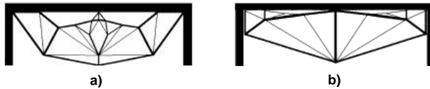
Figura 3.11 – a) solução mais leve encontrada pelo EifForm sem restrição à altura da treliça (massa = 1417 Kg); b) solução mais pesada gerada pelo EifForm sem restrição à altura da treliça (massa = 1468 Kg). Fonte: Shea e Cagan, 1999: 17.
