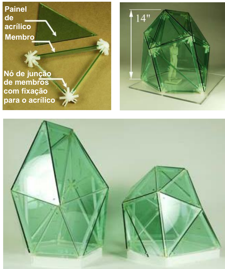
Figura I.V – Em cima à esquerda: unidade básica de montagem para cada plano triangular. Restantes: exemplos de modelos montados. Fonte: Shea et al., 2005.
