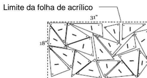
Figura I.IV – Rebatimento dos painéis de vidro ou acrílico. Fonte: Shea et al., 2005: 24.
