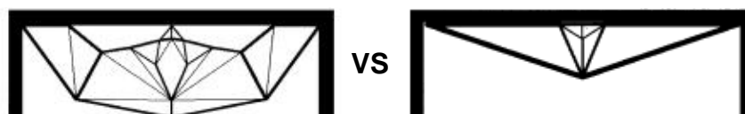
Figura 3.13 – À esquerda a solução mais complexa e à direita a configuração mais simples, do tipo Kingpost , obtidas pelo EifForm. Fonte: Shea e Cagan, 1999: 18.
