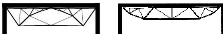
Figura 3.14 – Soluções onde a corda inferior é horizontal. Fonte: Shea e Cagan, 1999: 17.
