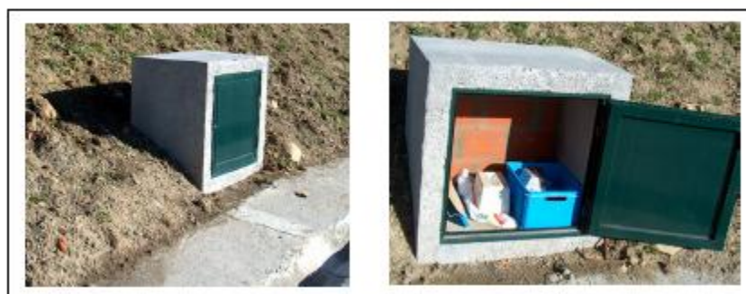
Figura 3.23 – Caixa existente em PK1+150 para colocar o datalogger do sensor ECH 2 O e o display do sensor HMT 337 (Maranha das Neves & Cardoso, 2006)
