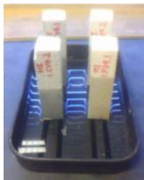
Figura 11- Ensaio de absorção de água por capilaridade.
