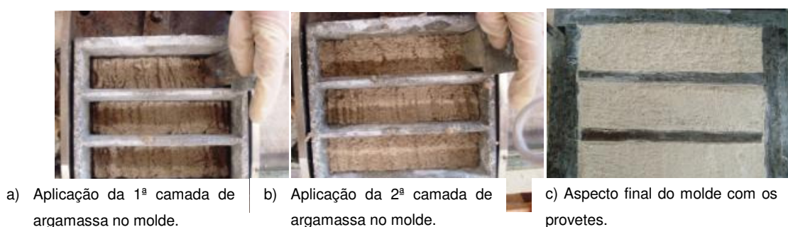
Figura 3- Descrição de algumas etapas do processo de preparação dos provetes prismáticos.
