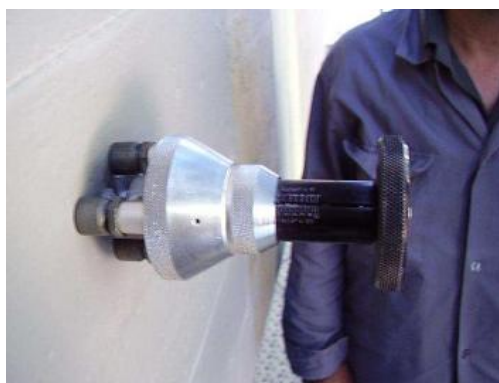
Figura 9 - Ensaio pull-off (Saraiva, 2007)
