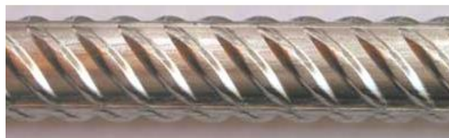
Figura 6 - Os varões de aço inoxidável não exibem a habitual camada de ferrugem que se encontra nos varões de aço de carbono (www.ugitech.com)
