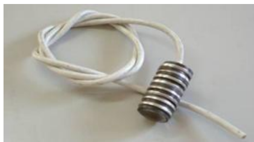
Figura 13 - Sensor de resistividade do betão com 7 níveis (Appleton e Costa, 2009)
