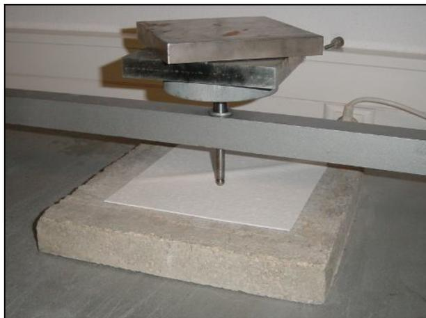
Figura 3.6 – Aparelho de ensaio de punçoamento estático.
