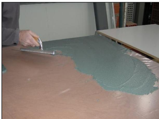
**Figura 3.9 – Aplicação de produto líquido de impermeabilização sobre película plástica, para preparação de provetes soltos.**
