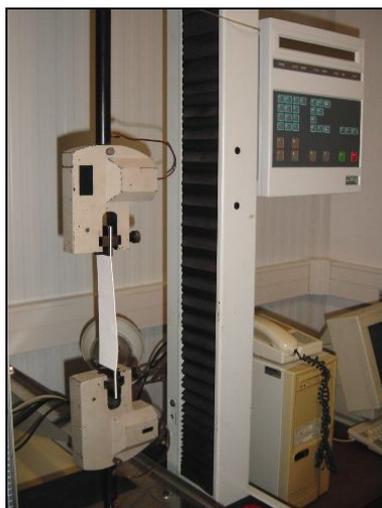
Figura 3.7 – Aparelho de ensaio de tracção.
