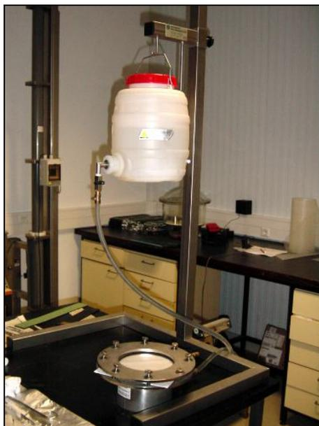
Figura 3.2 – Aparelho de ensaio de estanqueidade.
