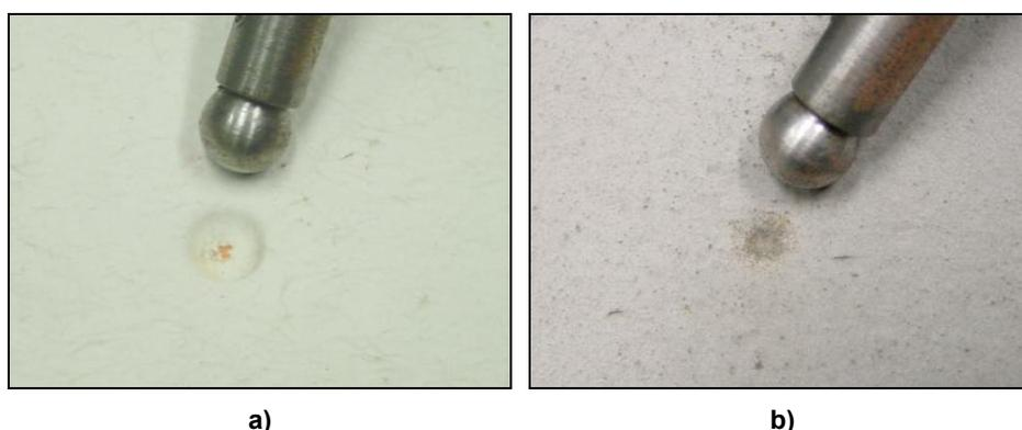
**Figura 4.6 – Punçoamento estático com carga de 200 N: a) revestimento acrílico fibroso com 2 demãos; b) revestimento cimentício não-armado com 2 demãos.**
