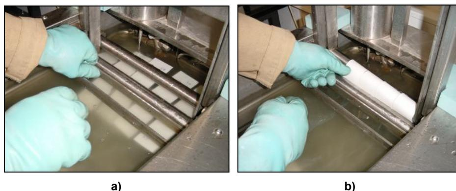
Figura 3.8 – Ensaio de flexibilidade a baixa temperatura: a) imersão dos provetes em posição horizontal; b) elevação do mandril de dobragem.
