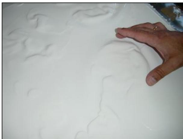
**Figura 3.14 – Bolhas de consistência espumosa, resultantes da interacção do produto à base de poliuretano com a película plástica subjacente de polietileno.**
