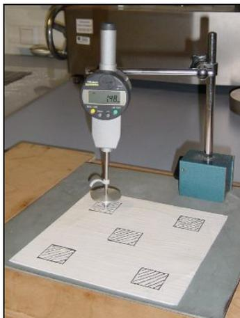
**Figura 3.12 – Comparador digital para avaliação de espessuras.**
