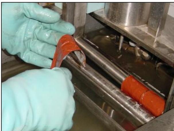
**Figura 4.14 – Ensaio de flexibilidade a baixa temperatura. Observação a olho nu para detectar eventual fissuração do revestimento.**
