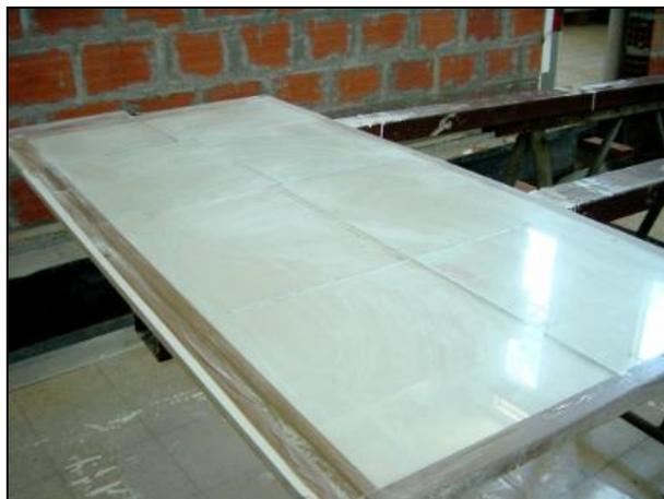
**Figura 3.11 – Placas de vidro polvilhadas com talco, para aplicação de produto à base de poliuretano.**
