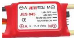
Figura 6.6 Variador de tensão com colocação do jumper na opção pretendida
