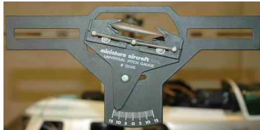
Figura 2.7 Pá de helicóptero e de um medidor de ângulos medindo +13°
