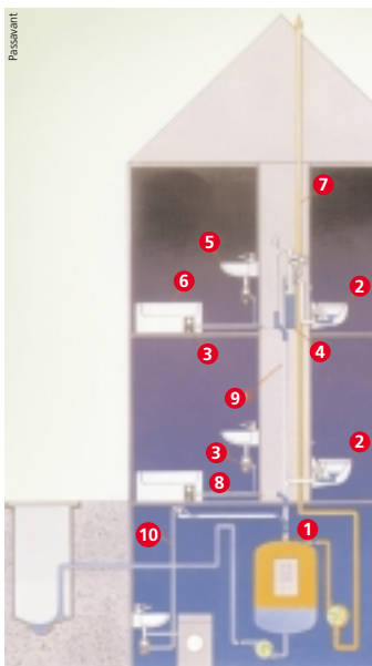
Sistema de drenagem de esgotos a vácuo
