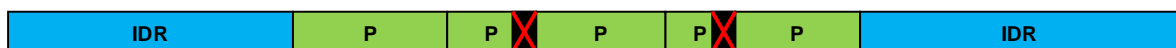
Figura 11 – Exemplo da métrica do último pacote IP, com descarte nas tramas mais pequenas.
