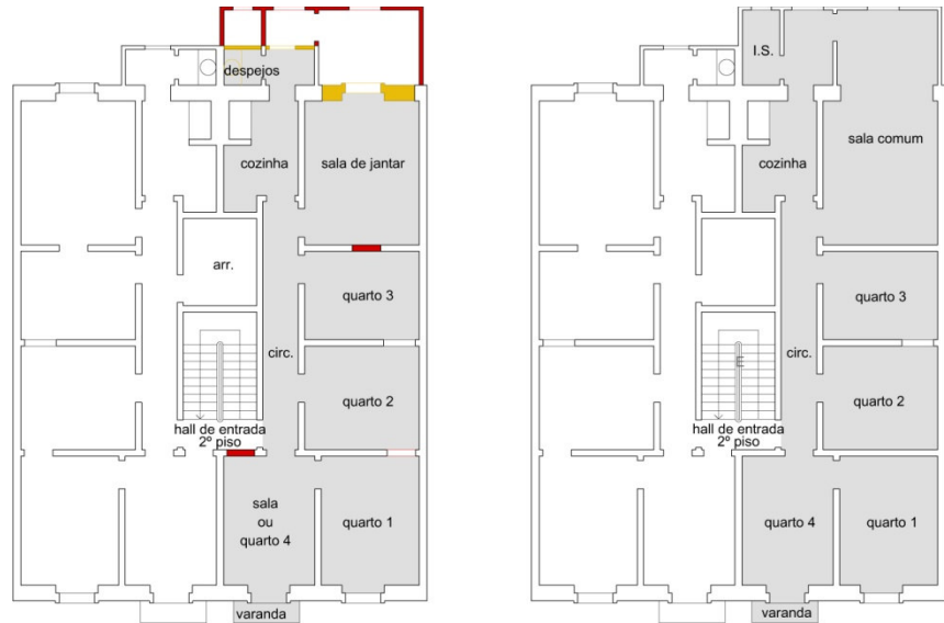
Figs.95 e 96 – Planta de alterações sobre o projecto original (à esquerda) e Planta da situação actual (à direita) – Caso 1
