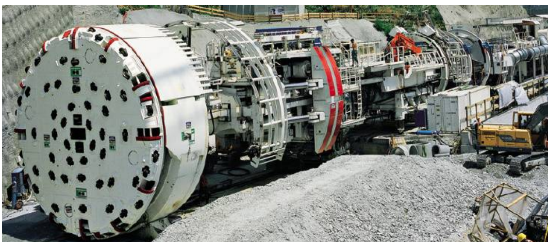
Figura 2.8 – Tuneladora de escudo com confinamento contra-pressão [3]
