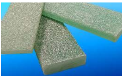
Figura 3.14 – Pregagens de fibra de vidro [13]
