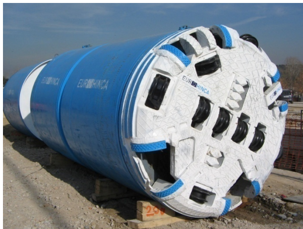
Figura 2.5 – Tuneladora com escudo de confinamento líquido [3]
