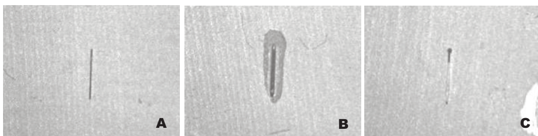
Figura 3.3.: Tipos de canais obtidos através de observação com câmara CCD; A) Canal regular; B) Canal com zona adjacente com perda de compostos orgânicos por evaporação; C) Canal irregular.
