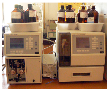
Figura 9 - Cromatógrafo 600E da Waters (módulos Controlador 600E, Bombas 600E, desgaseificador In-Line Degasser da Waters e Injetor de amostras 717 plus Autosampler ).
