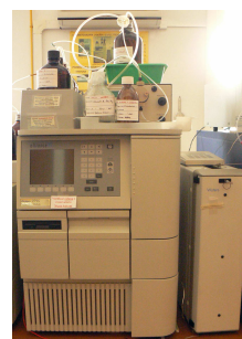
Figura 10 – Cromatógrafo Alliance 2795 da Waters e forno de coluna da Waters.
