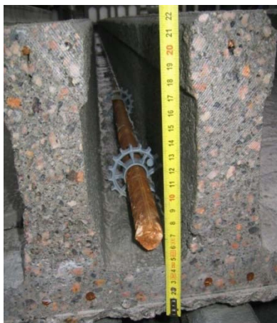
Figura 2.5 – Altura mínima da pré-laje minos 3
