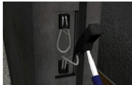
Figura 2.34 – Ligação vertical e horizontal entre painéis de parede
