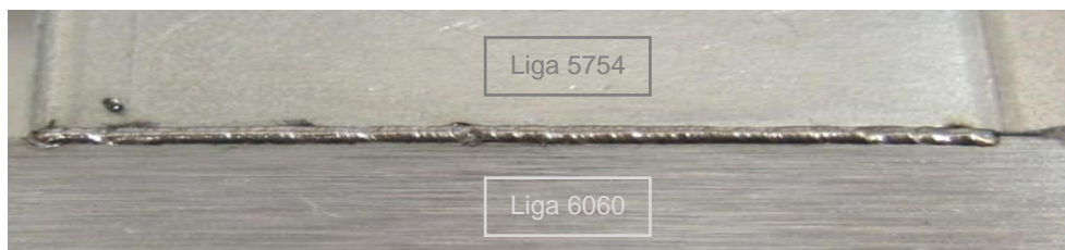
Figura 5.70 – Soldadura com fio de adição 4043
