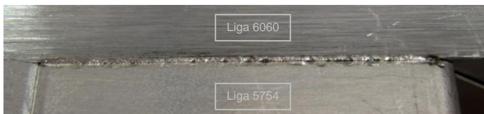
Figura 5.69 – Soldadura sem material de adição (Autogéneo)
