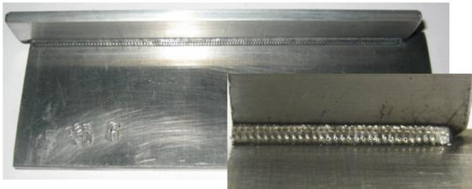
Figura 5.30 – Cordão de soldadura com material de adição 5356
