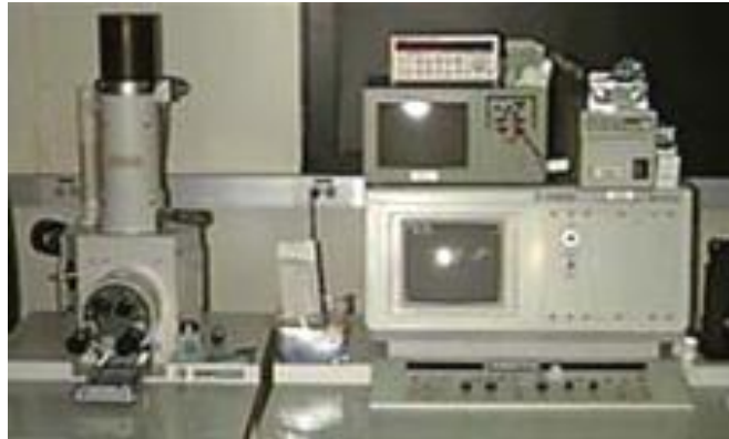
Figura A.1 – Microscópio de varrimento - SEM Hitachi S-2400 [48]
