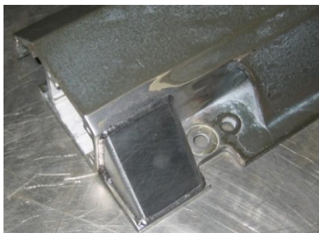
Figura 5.65 – Peça pretendida soldada (liga 6063-T6 com 6082-T6)
