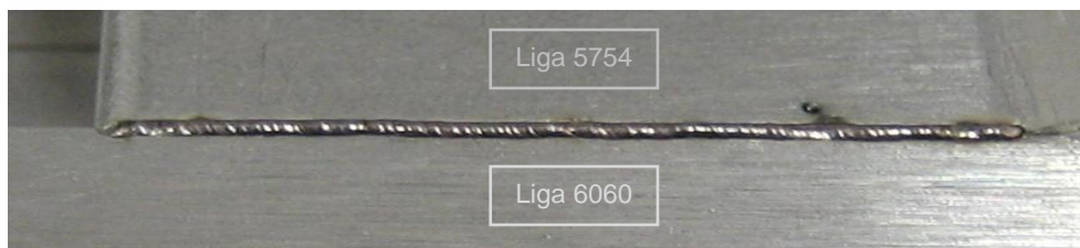
Figura 5.71 – Soldadura com fio de adição 4047
