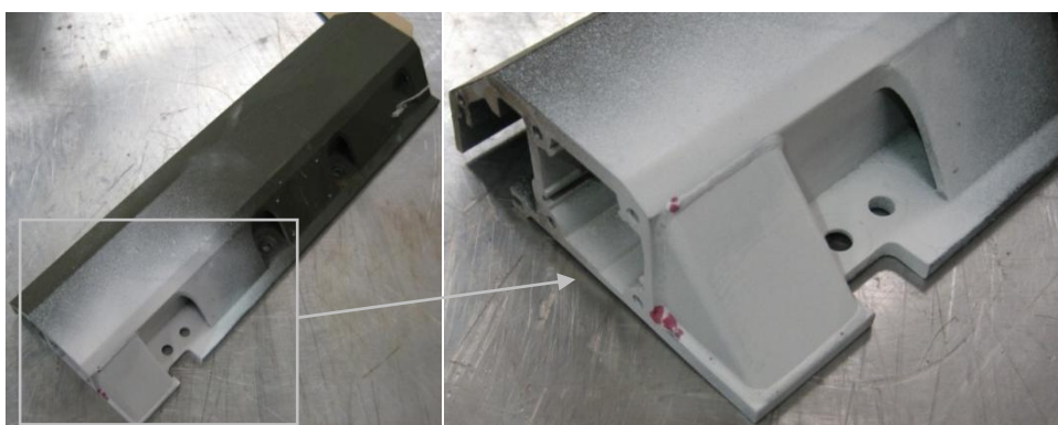
Figura 5.66 – Ensaio de líquidos penetrantes à peça soldada (liga 6063-T6 com 6082-T6)
