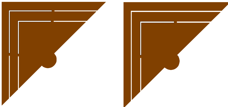
Figura 3.19. Detalhes das configurações 1, à esquerda e 2, à direita, para a antena triangular de tripla banda (a linha microstrip e o plano de terra foram omitidos para maior clareza do desenho).
