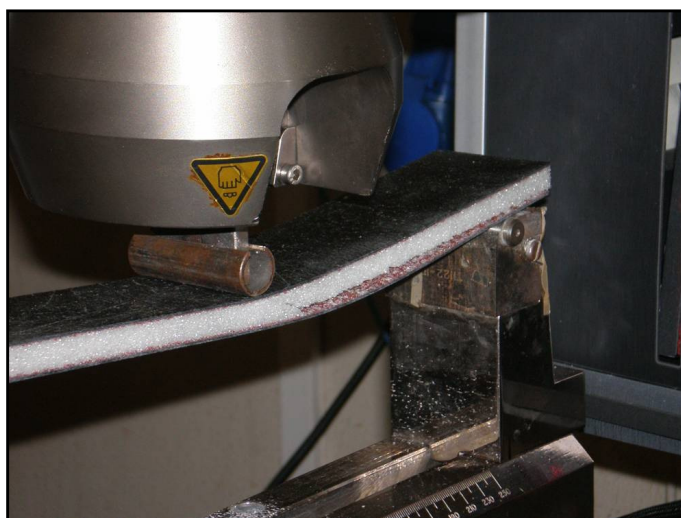
Figura 21 - Falha por descolamento do núcleo em relação às faces nos ensaios ASTM C 393
