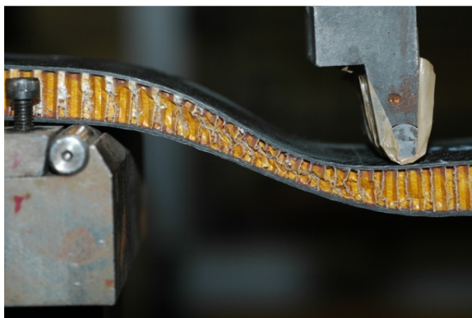
Figura 20 - Falha por corte do núcleo nos ensaios ASTM C 393
