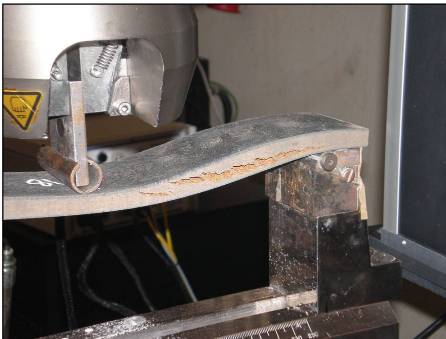
Figura 44 - Fenda típica ocorrida nos ensaios dos provetes de aglomerado de cortiça
