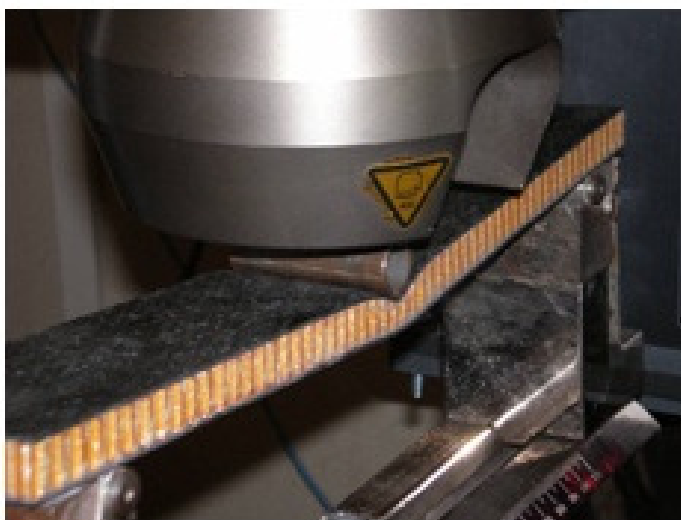
Figura 19 - Falha à compressão da face sujeita a alongamento nos ensaios ASTM C 393
