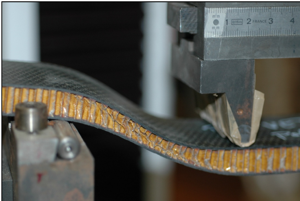
Figura 48 - Falha do núcleo dos ensaios de flexão em 4 pontos de provetes Ninho de Abelha
