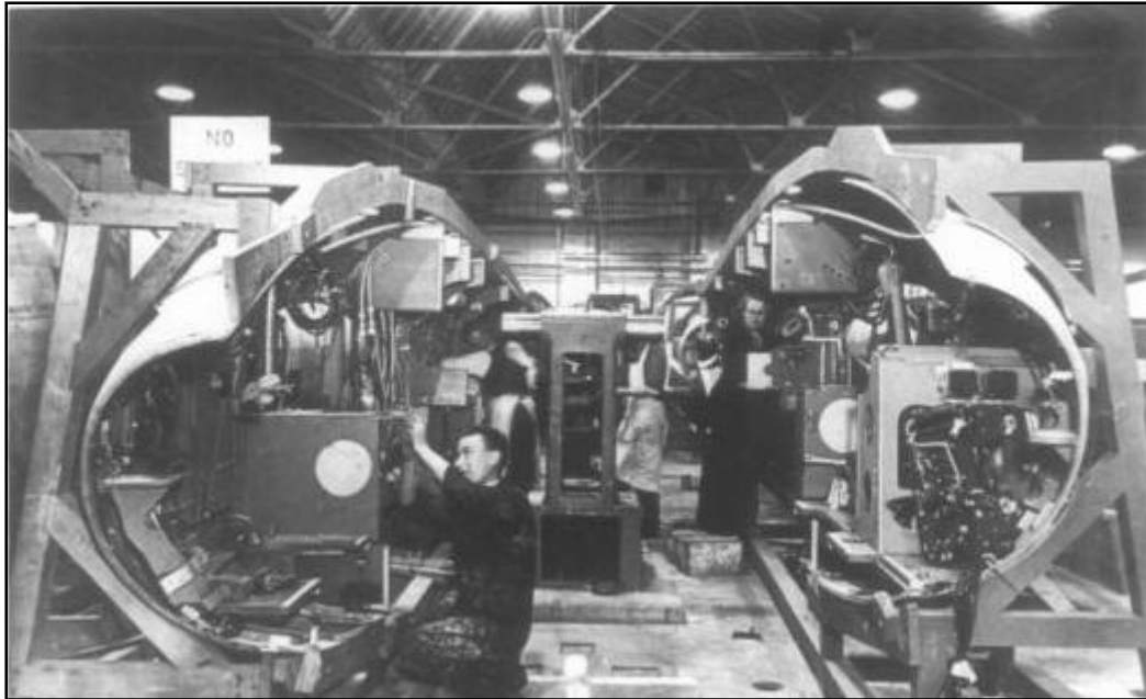
Figura 6 - Construção das metades da fuselagem do Mosquito, (BISHOP, 2000).
