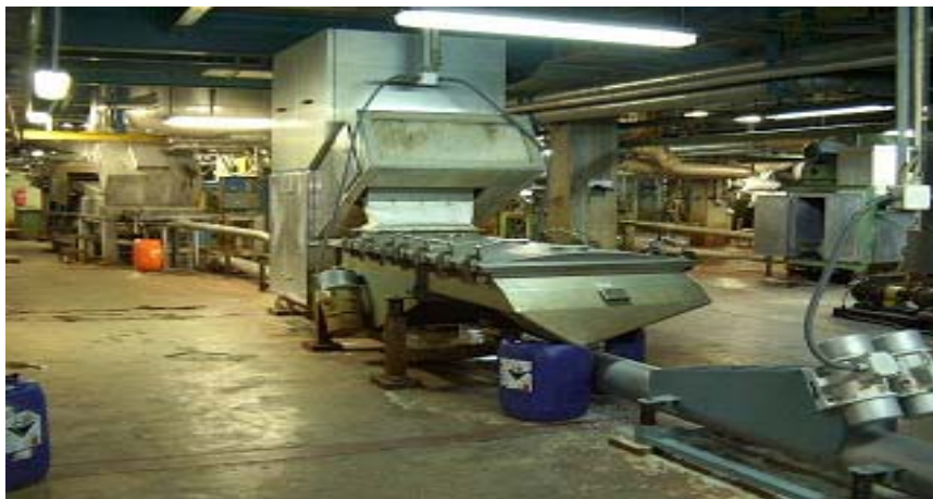
Figura 12 – Sistema de extrusão, corte, secagem e peneiro.
