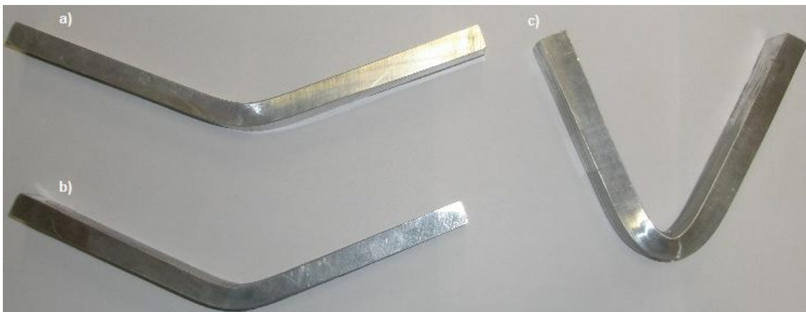
Figura 5.38 – Provetes de flexão ensaiados da liga de alumínio AA5083-O: a) Material base, b) PFLS e c) PFLV
