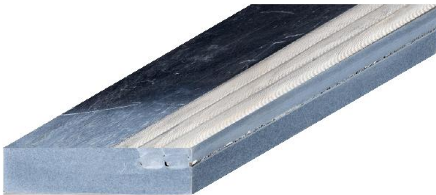
Figura 4.8 – Representação 3-D de canais (defeito em volume)
