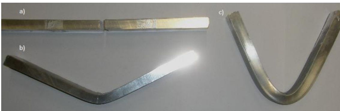
Figura 5.36 – Provetes de flexão ensaiados da liga de alumínio AA7022-T6: a) Material base, b) PFLS e c) PFLV
