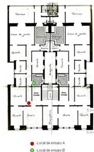
Figura A. 7: Locais onde se colocou a unidade triaxial, no 4º piso, a direcções X é paralela à fachada e a direcção Y é perpendicular à fachada.
