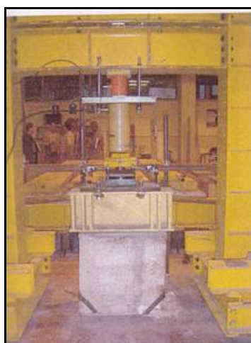
Figura A. 4: Pórtico para ensaio de compressão monotónica em parede de alvenaria de tijolo da Praça de Touros do Campo Pequeno [18].
