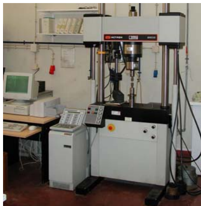
Fig. 22 – Máquina de ensaios mecânicos "Instron 8502" utilizada para a determinação da resistência à compressão
