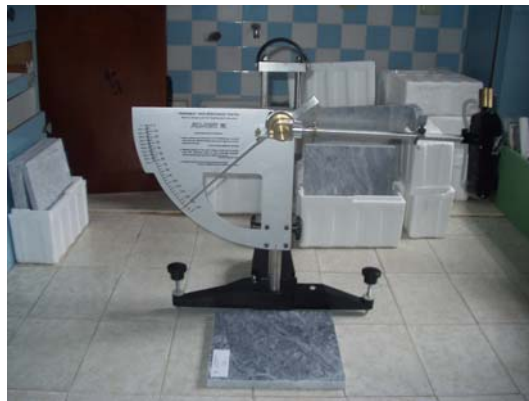
Fig. 23 – Pêndulo britânico - Mastrad Skid Tester S885
