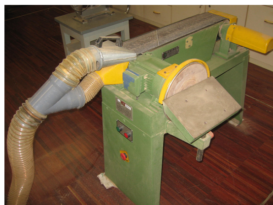
Figura G.15 – Lixa e ar comprimido para uniformizar e limpar a superfície do provete, respectivamente.
