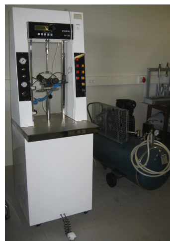
Figura G.17 – Prensa para a realização dos ensaios de torção das rolhas (TC 2000).
