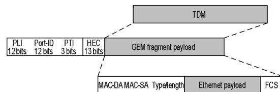
**Figure 4.4. GPON encapsulation method**
