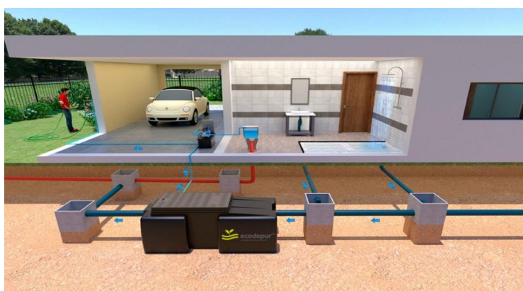
Figura 21 - Sistema Ecodepur de aproveitamento de águas cinzentas (EcoDepur, 2021).
