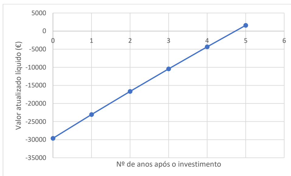
Figura 35 – Representação gráfica do valor atualizado líquido para o sistema reciclador de águas cinzentas, para uma taxa de atualização de 2,5%.
