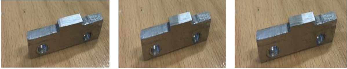
Figura 5.8. Captura fotográfica sequencial da face do provete maquinada após um ensaio em condições estáticas.
