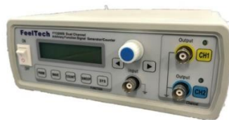
Figura 3.15. Gerador de sinais FeelTech® FY3200S Dual Channel.
