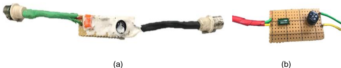
Figura 3.14. Pontes retificadoras: (a) Ponte para ensaios em regime quase-estático; (b) Ponte para ensaios em regime de alta velocidade.
