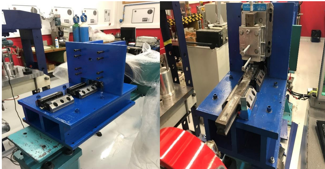
Figura 3.2. (a) Estrutura; (b) Cinemática da máquina de ensaios.
