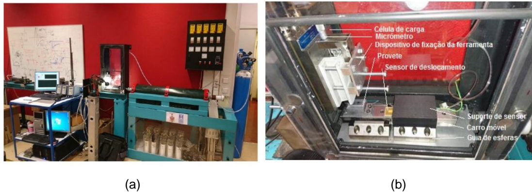
Figura 2.16. Aparato experimental desenvolvido por Fernandes (2017): (a) Aparato experimental funcional; (b) Máquina de ensaios.
