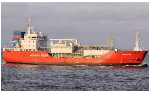
Nome: Coral Star Tipo: Navio tanque Função: Transporte de Etileno Tecnologia:DF
