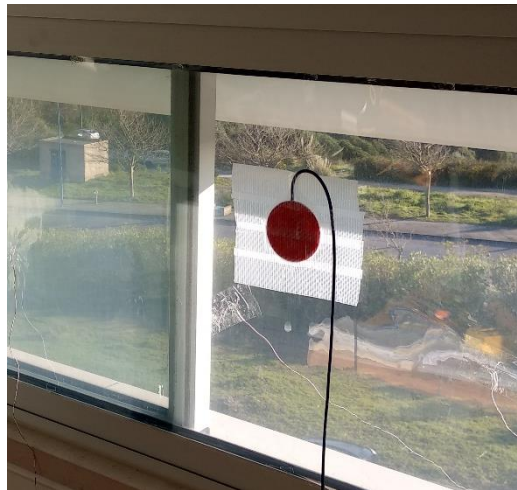
Figura 4-10 Fluxímetro colocado no envidraçado, vista interior.
