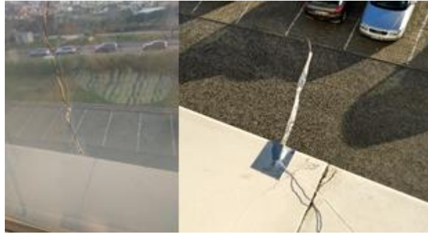
Figura 4-9 Termopares (para medição da temperatura superficial interior à esquerda e da temperatura ambiente exterior à esquerda).
