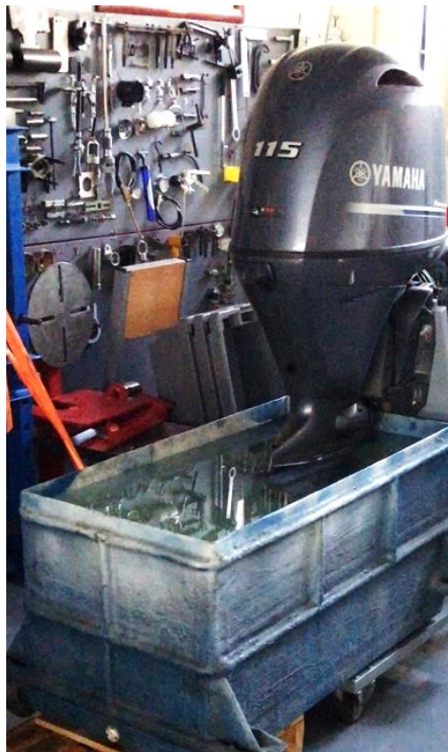
Figura 34: Montagem do motor durante o ensaio de determinação da taxa de corrosão/penetração do ânodo
