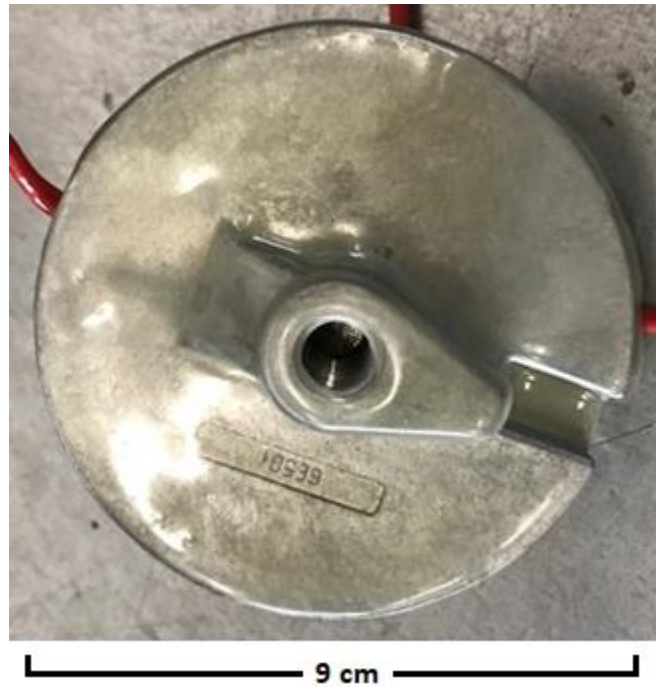
Figura 30: Estabilizador de direcção após revestimento de epóxi.
