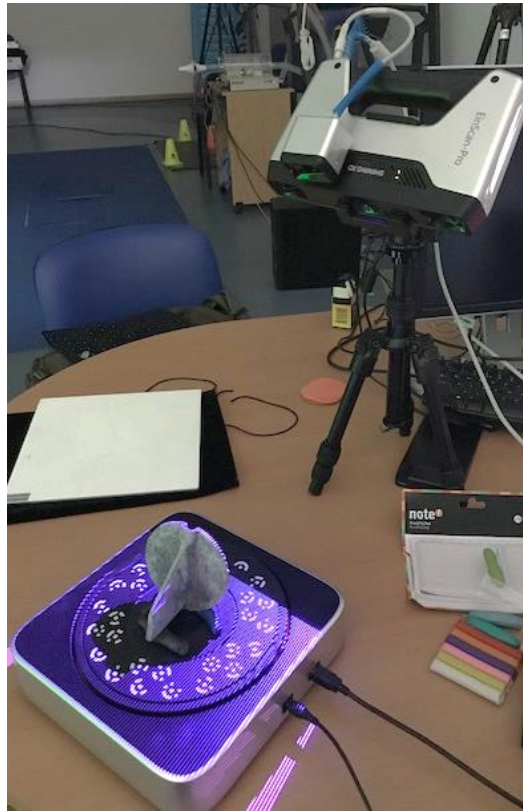
Figura 36: Conjunto scanner 3D utilizado para a obtenção do valor da área da superfície do ânodo
