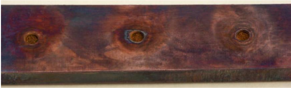
Figura 23: Ensaio de variação de área entre o cátodo e o ânodo (Placa em Cobre e Rebites em Aço) [36].
