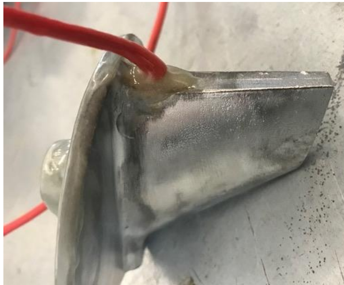
Figura 33: Ligação e Protecção da ligação entre o ânodo e o cabo de ligação ao amperímetro
