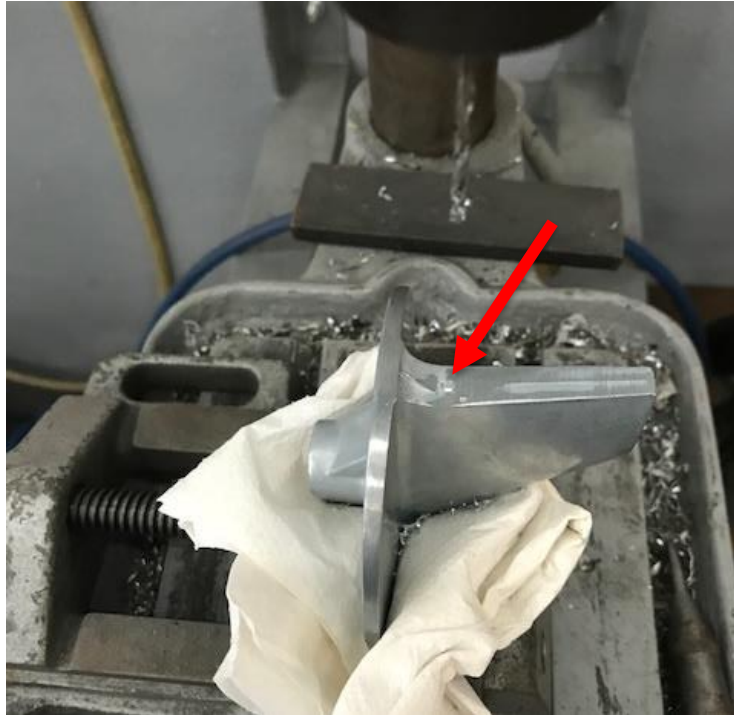
Figura 32: Furo realizado no ânodo
