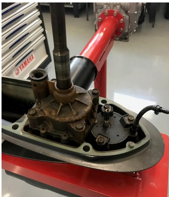
Figura 42: Bomba de água
