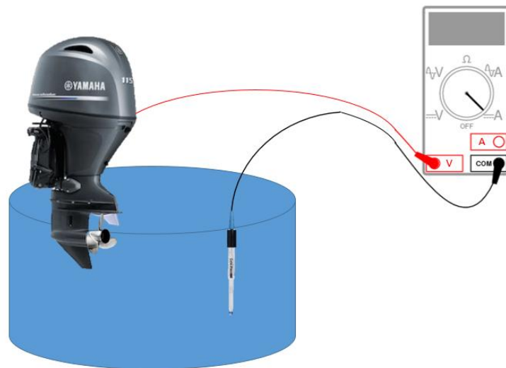
Figura 35: Esquema montagem da medição do potencial eléctrico recorrendo a um eléctrodo de referência de Calomelanos saturado (ECS)
