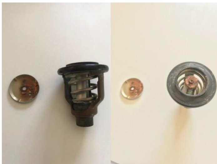
Figura 41: Termostato com falha (A união entre o perno e a chapa da válvula falhou por efeitos de da corrosão)
