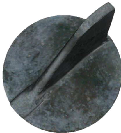
Figura 44: Imagem obtida pelo Scan 3D do ânodo em estudo, após os 31 dias da duração do ensaio.
