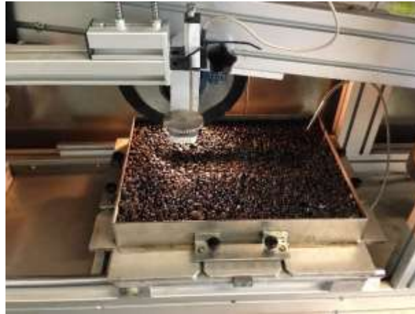
Figura 3.24 – Exemplo de ensaio wheel-tracking (Crucho, 2018)
