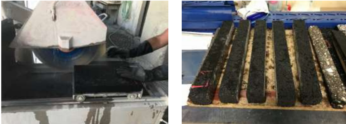
Figura 3.20 – Serragem das lajetas (esquerda) e provetes prismáticos obtidos após serragem (direita)
