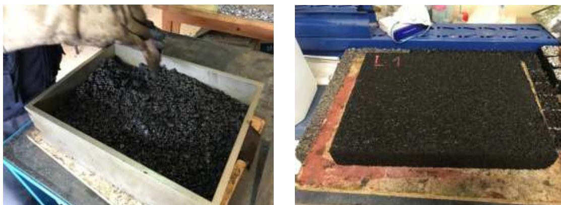
Figura 3.19 – Introdução da mistura molde (esquerda) e aspeto final da lajeta após compactação e desmoldagem (direita)
