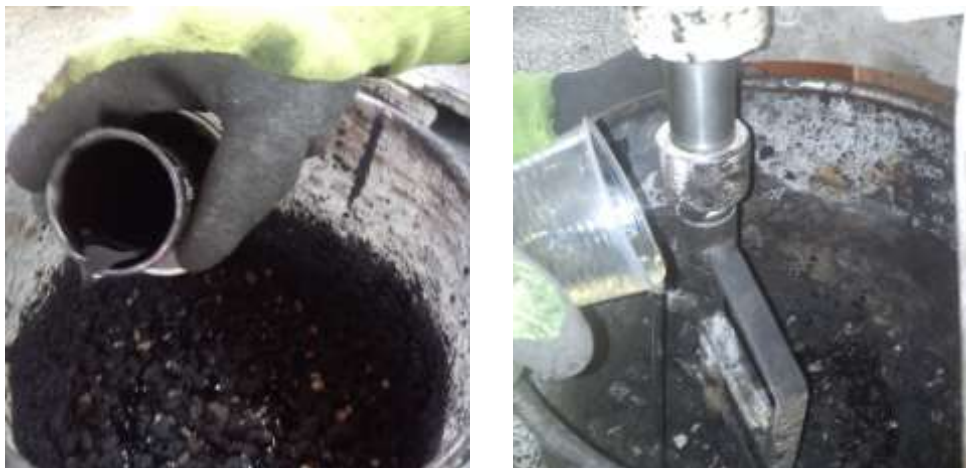
Figura 3.6 – Introdução do betume virgem (esquerda) e do OAU (direita) na mistura
