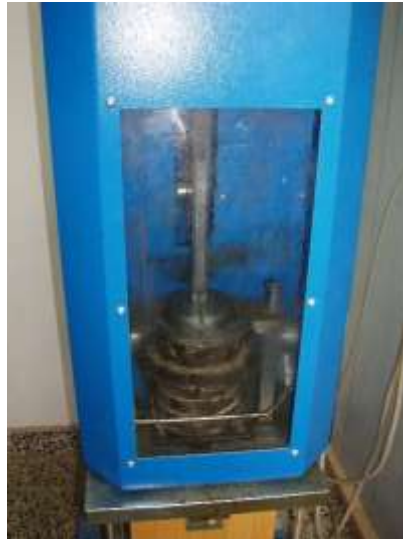
Figura 3.7 – Compactador de impacto utilizado
