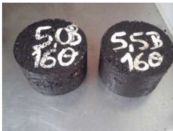
Figura 3.10 – Aspeto final dos provetes após desmoldagem
