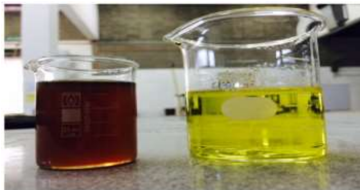
Figura 2.8 – Óleo tratado/Bio-óleo (direita) e óleo não tratado (esquerda) (Azahar et al. , 2016)
