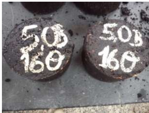
Figura 3.13 – Aspeto dos provetes após ensaio de compressão Marshall
