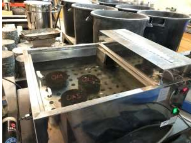
Figura 3.26 – Banho termostático utilizado no condicionamento dos provetes
