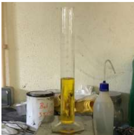
Figura 3.3 – OAU utilizado no fabrico da mistura rejuvenescida
