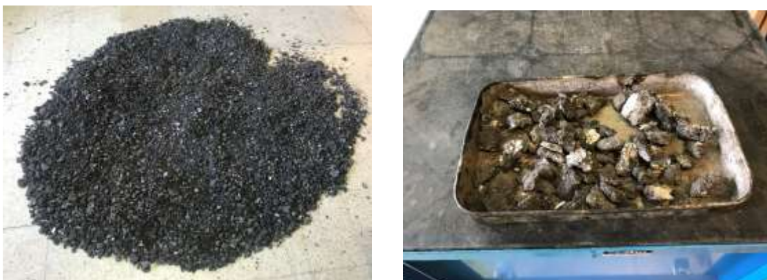
Figura 3.17 – Material fresado selecionado (esquerda) e torrões retirados do fresado (direita)
