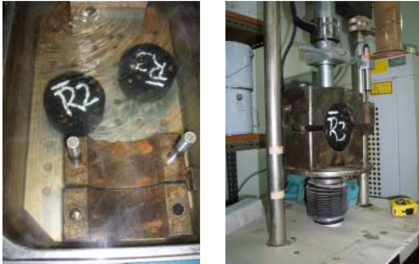
Figura 3.12 – Banho termostático (esquerda) e ensaio de compressão Marshall (direita)
