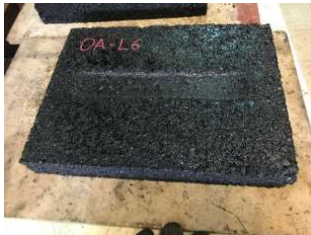
Figura 3.25 – Aspeto das lajetas após a realização do ensaio wheel-tracking
