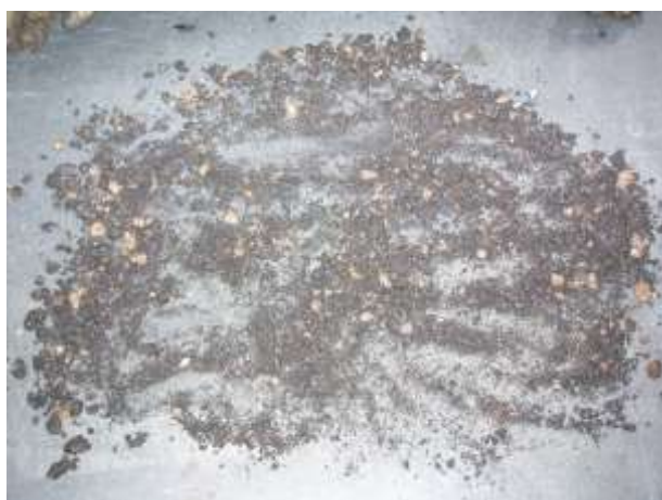
Figura 3.14 – Desagregação do provete selecionado
