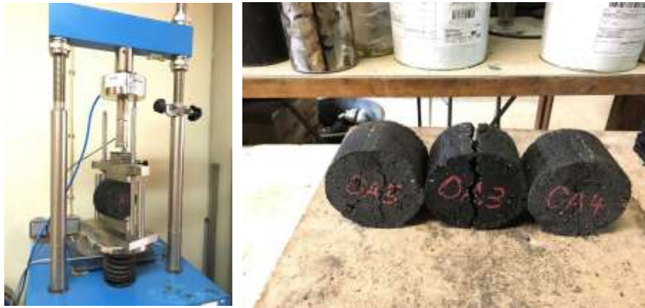
Figura 3.27 – Prensa utilizada para a realização do ensaio ITS (esquerda); Aspeto provetes após realização do ensaio ITS (direita)
