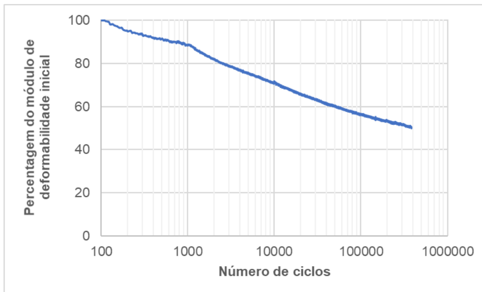
Figura 4.4 – Ensaio de fadiga realizado para o provete OA13
