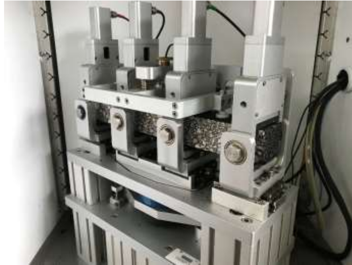
Figura 3.22 – Equipamento Four-Point-Bending utilizado no ensaio de rigidez e de resistência à fadiga
