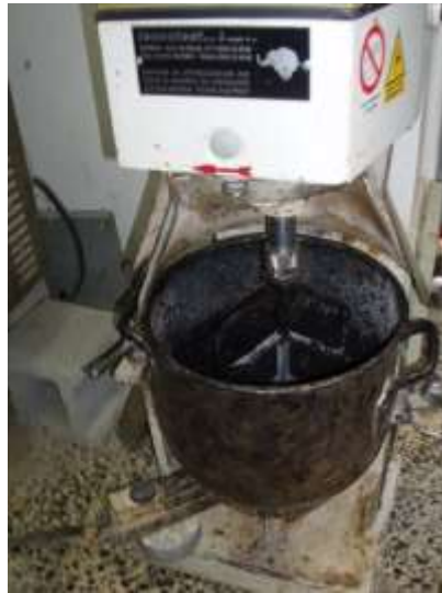
Figura 3.5 – Misturadora utilizada no fabrico da mistura
