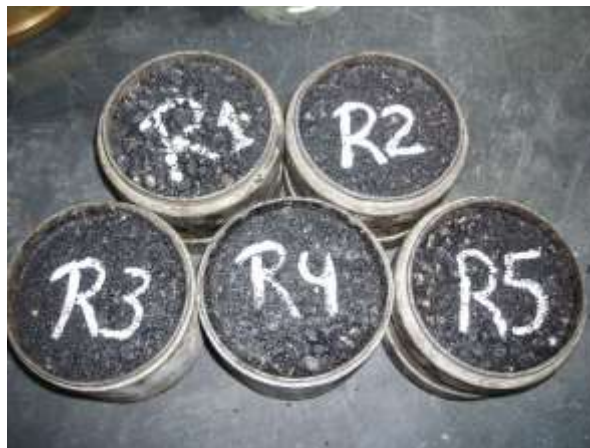
Figura 3.8 – Provetes após compactação
