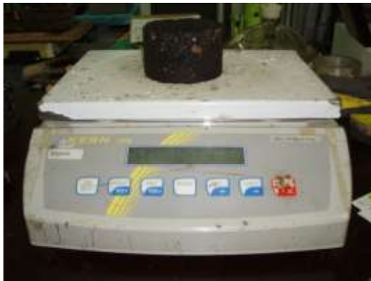
Figura 3.11 – Pesagem do provete seco (esquerda) e submerso (direita)
