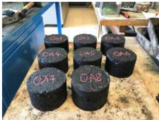
Figura 3.21 – Aspeto final dos provetes cilíndricos fabricados
