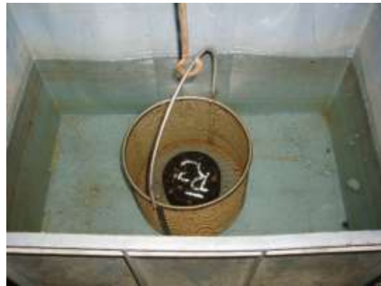
Figura 3.11 – Pesagem do provete seco (esquerda) e submerso (direita)
