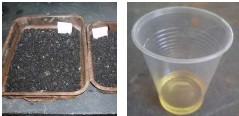
Figura 3.4 – Material fresado (esquerda) e OAU (direita) utilizados no fabrico da mistura
