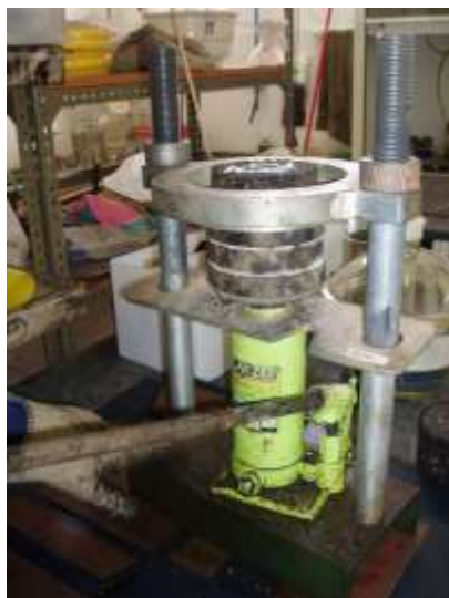
Figura 3.9 – Desmoldagem de um dos provetes fabricados
