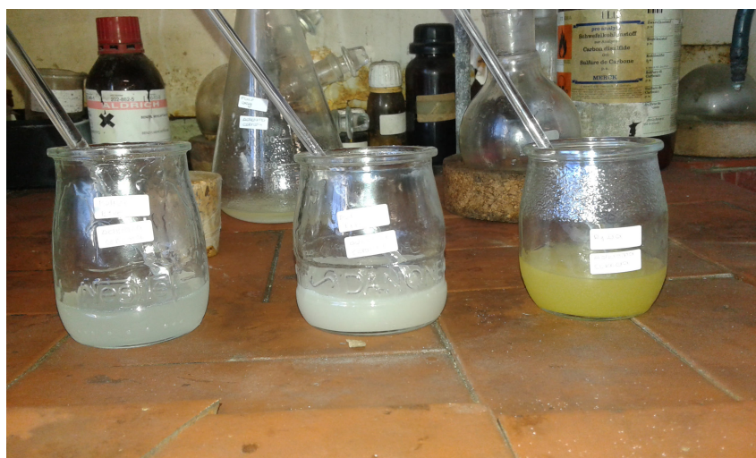
Figura 5.2: Polióis sintetizados com 3h de reação e a partir de OAN, OAU e OAMU, da esquerda para a direita.
