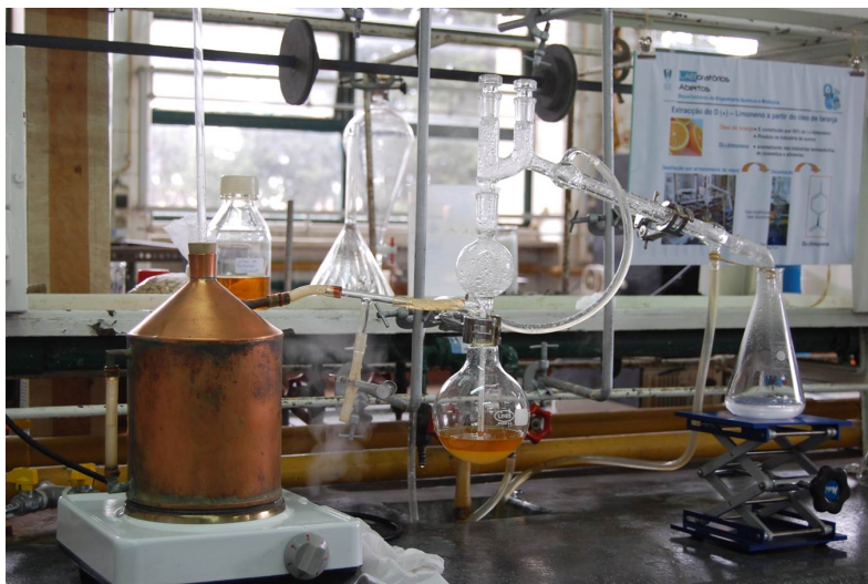
Figura 4.6: Extração de (+)-limoneno por destilação por arrastamento de vapor do óleo de laranja.
