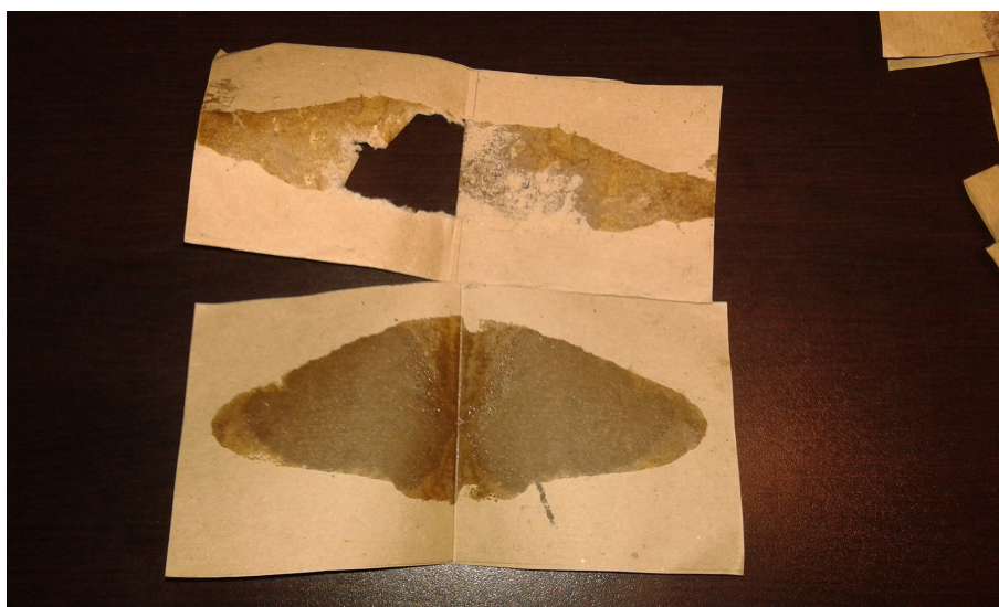
Figura 4.14: Amostras com papel descolado com e sem rasgo.
