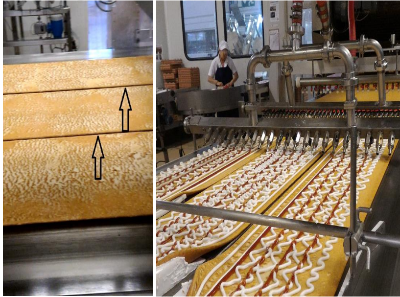
Figura 17 – Da esquerda para a direita. Imagem real do segundo corte da massa com indicação do corte efetuado na massa. Imagem real do equipamento 13 – deposição de cremes/chantili/ doce.
