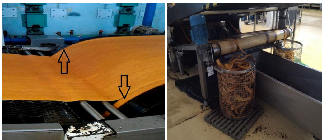
Figura 16 – Da esquerda para a direita. Imagem real do primeiro corte da massa (as setas na figura indicam as tiras de massa que servem para a preparação da granela). Imagem real dos baldes com fitas de granela (vista por baixo do tapete rolante).
