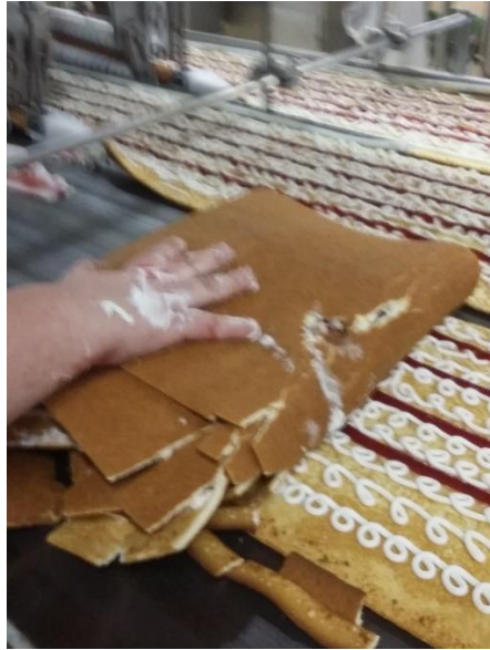
Figura 43 - Imagem real. Colaborador recolhe massa de maneira a ajustar os enroladores. Massa considerada desperdício.
