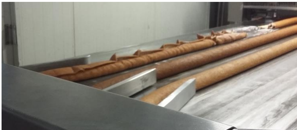
Figura 44 – Imagem real. Situação de mau ajuste dos enroladores com conseqüente má qualidade das tortas.
