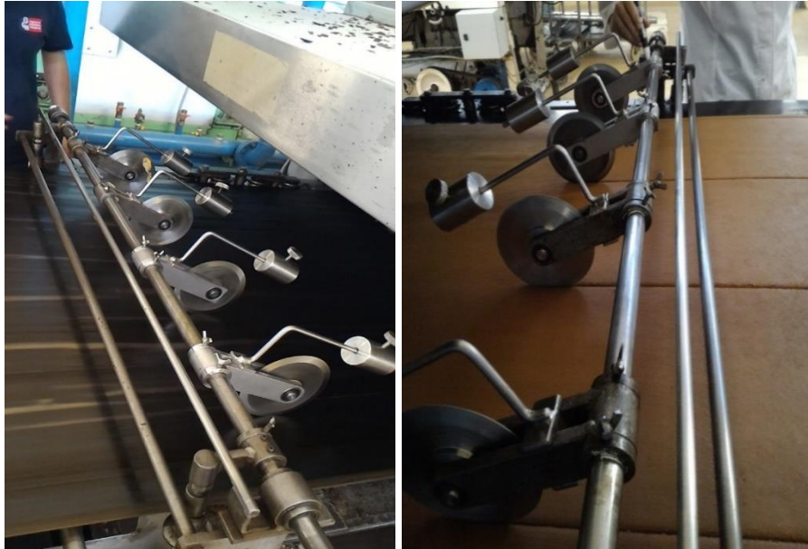
Figura 52 – Imagem real da melhoria implementada no corte da massa
