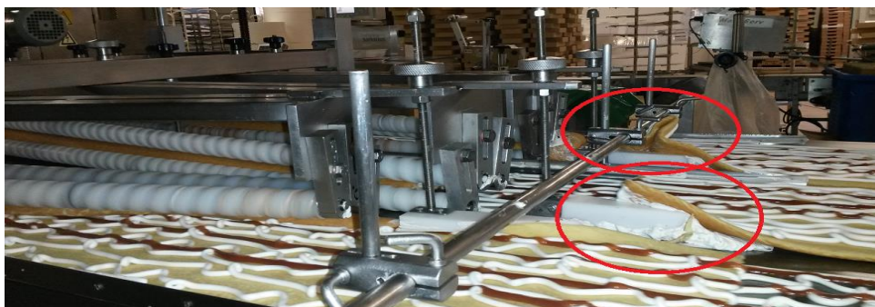
Figura 42 – Imagem real do enrolamento defeituoso de duas das três tortas com consequente má formação da torta
