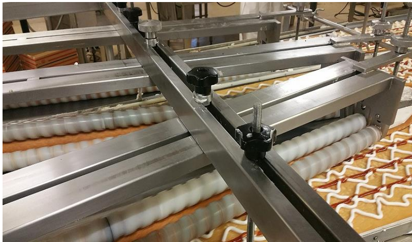
Figura 20 - Imagem real da zona dos enroladores. Pormenor dos vários ajustadores de posição.
