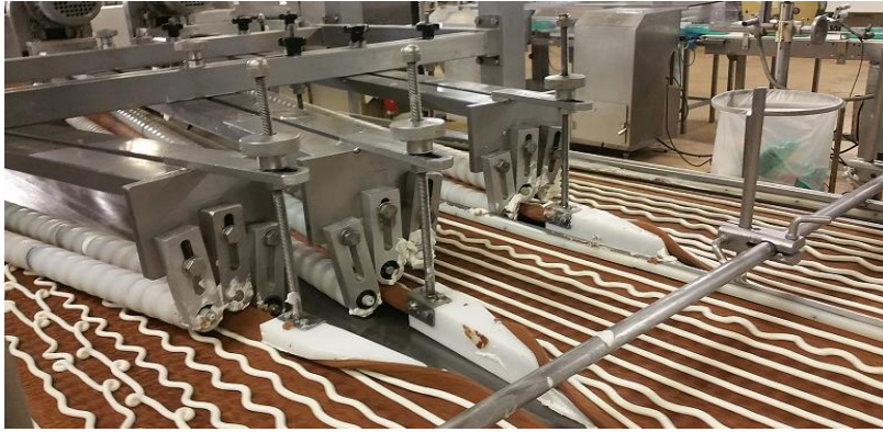
Figura 19 – Imagem real da zona dos enroladores. Pormenor do enrolamento da massa.
