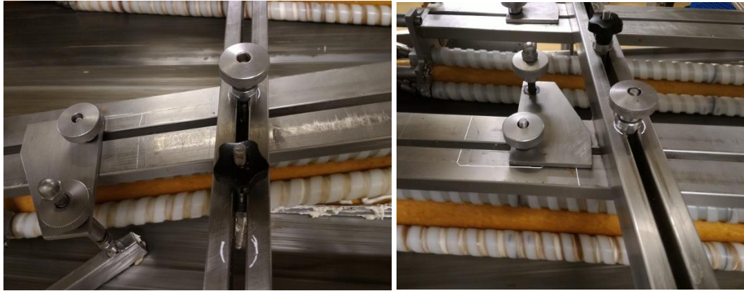
Figura 49 – Imagem real da ajuda visual presente nas ferramentas de enrolamento para o seu ajuste
