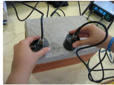
Figura 3.24 - Realização do ensaio (método indirecto)
