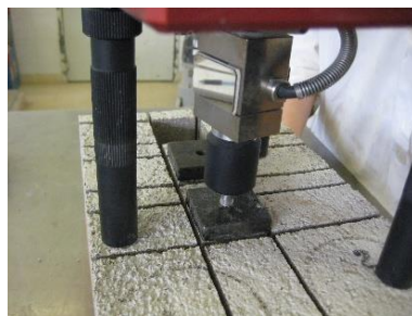
Figura 3.26 - Pormenor das pastilhas e máquina de arrancamento
