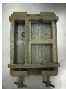
Figura 3.10 - Molde para provetes prismáticos 80x70x25 mm
