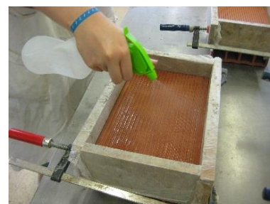
Figura 3.11 - Cofragem e humedecimento do tijolo
