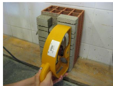
Figura 3.29 - Realização do ensaio com esclerómetro pendular do tipo PT
