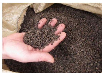
Figura 2.2 - Granulado de cortiça expandida [W1]
