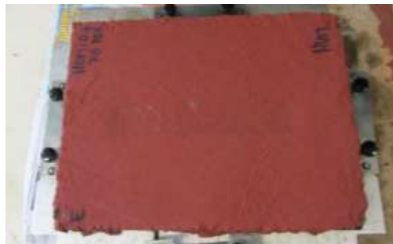
A5.2 - Laje E após 2000 ciclos
