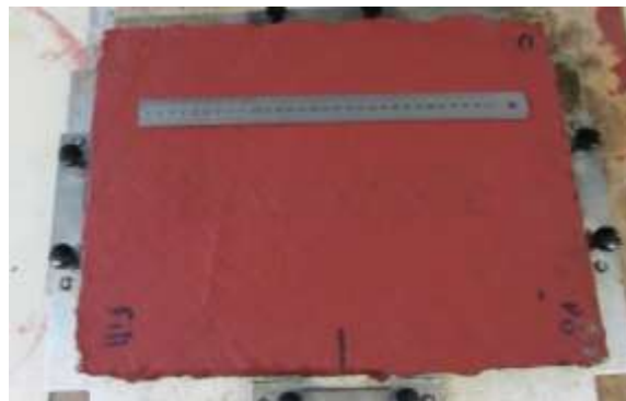
A3.2- Laje C após 2000 ciclos
