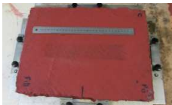
A3.6- Laje C após 10000 ciclos
