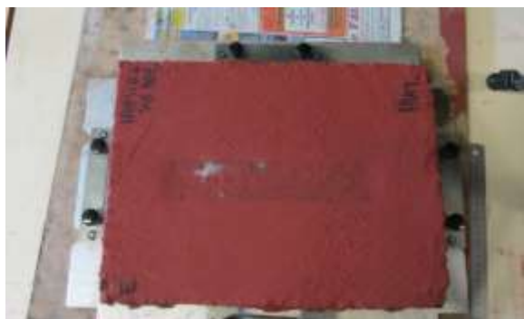
A5.5- Laje E após 8000 ciclos
