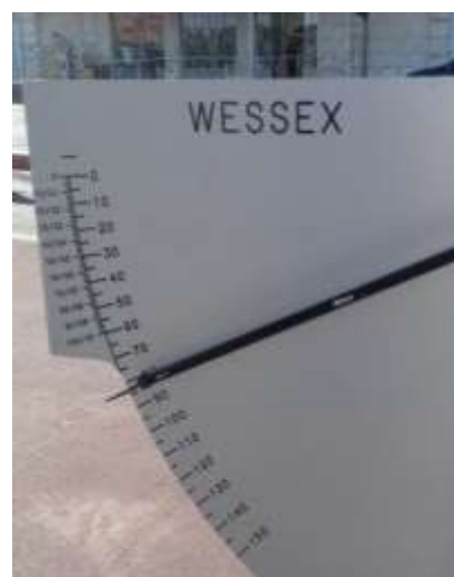
Figura 4.10- Escala de medição e ponteiro
