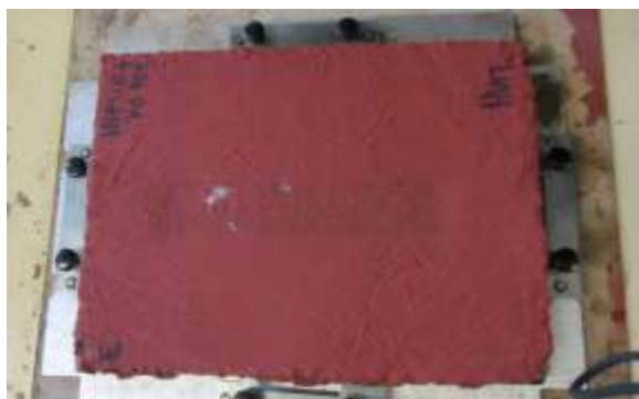
A5.3- Laje E após 4000 ciclos
