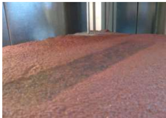
Figura 4.7- Aspeto do revestimento superficial após ensaio de resistência ao desgaste por rolamento
