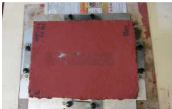
A5.4- Laje E após 6000 ciclos
