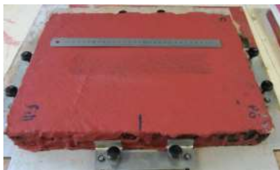
A3.5- Laje C após 8000 ciclos
