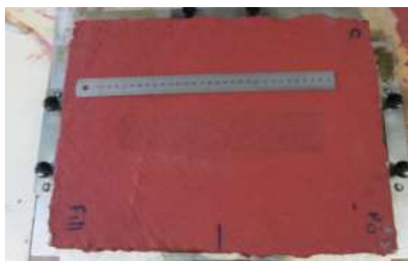
A3.3- Laje C após 4000 ciclos
