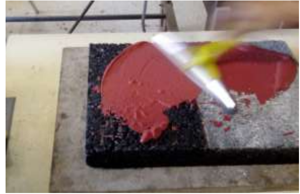
b) Espalhamento do revestimento
