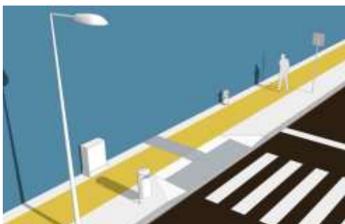
Figura 2.5 - Zona de atravessamento em passeios novos (CML, 2015)
