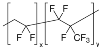
Figura 1.3.1- Estrutura química do copolímero de fluoreto de vinilideno e hexafluorpropileno (PVDF-co-HFP) [2].
