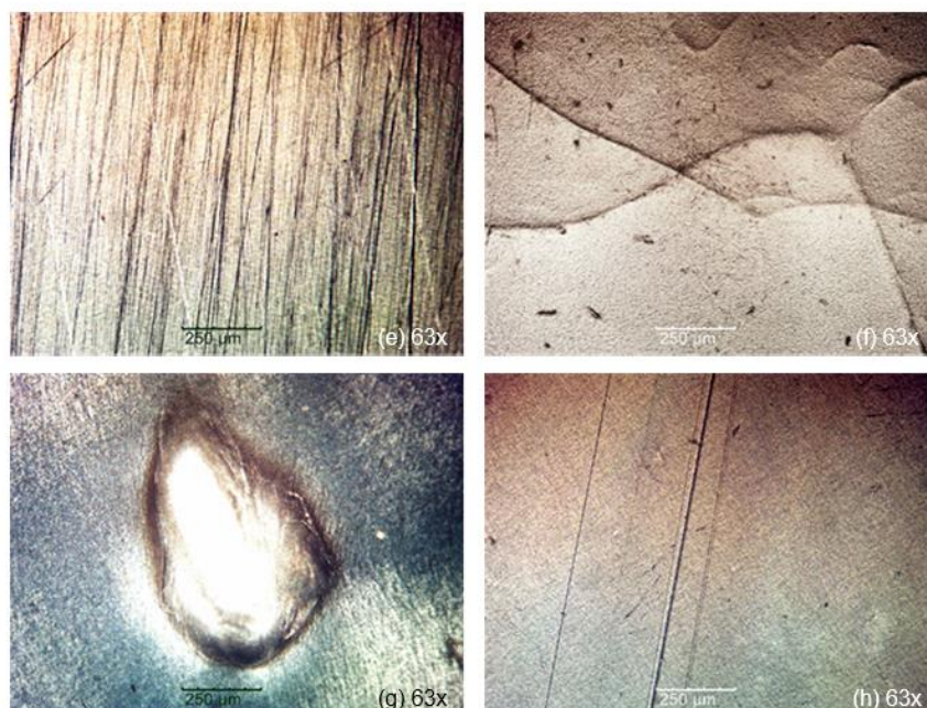
Figura 2.3.3. - Observação de defeitos nos filmes de PE no microscópio ótico, em (e) filme de LDPE antes de limpeza, (f) filme de LLDPE com “pele de tubarão”, (g) com gel e (h) após AP.
