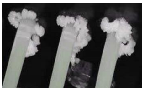
Figura 1.2.10- Presença de “babas” à saída da fiação capilar [29].
