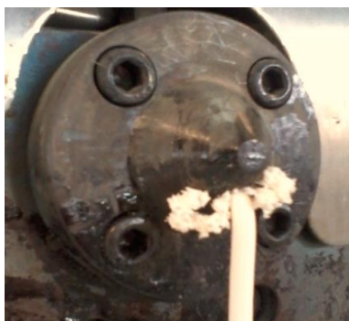
Figura 2.2.4. – Presença de “babas” durante a limpeza da extrusora.
