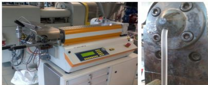
Figura 2.2.1. – Extrusora e fieira capilar.
