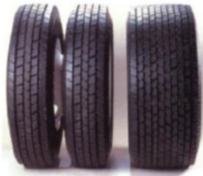
Figura 3 - Exemplo da configuração de pneus "dois a dois" usada antigamente (à esquerda) e dos novos pneus individuais de baixa resistência ao rolamento (à direita) [23]
