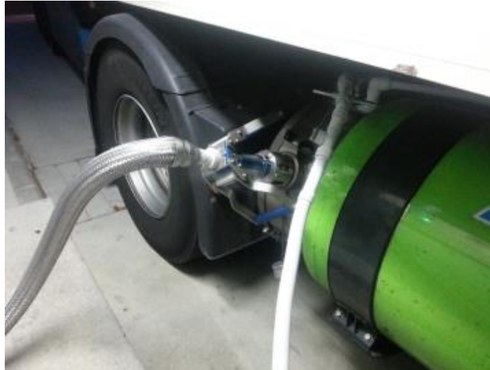
Figura 17 - Exemplo do abastecimento da viatura a gás natural
