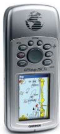
Figura 9 - GPSMap 76 CSx da Garmin, utilizado para a recolha dos dados relativos à dinâmica e topografia [73]
