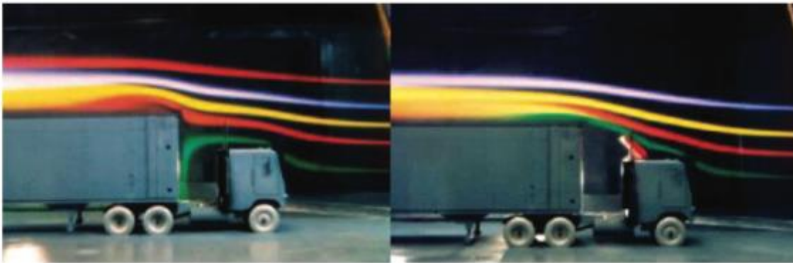
Figura 2 - Exemplo do efeito da introdução de apêndices aerodinâmicos para a redução da resistência aerodinâmica [20]
