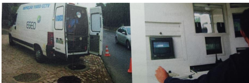
Figura 5.1 - a) Carrinha de inspeção CCTV b) Inspetor a controlar em tempo real a câmara (Gomes, 2013)
