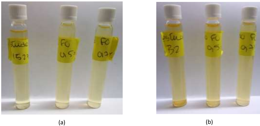
Figura 46 – Comparação entre soluções estáveis (a) e soluções precipitadas (b).
