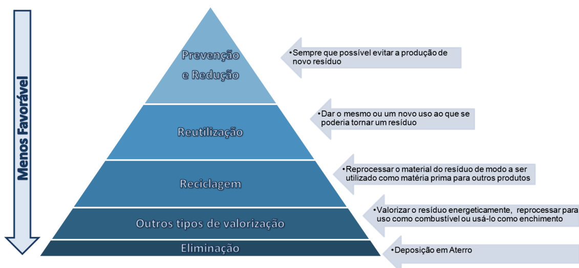
Figura 1-2 Hierarquia de gestão de resíduos, estabelecida na legislação europeia (Adaptado de Directiva 2008/98/CE)
