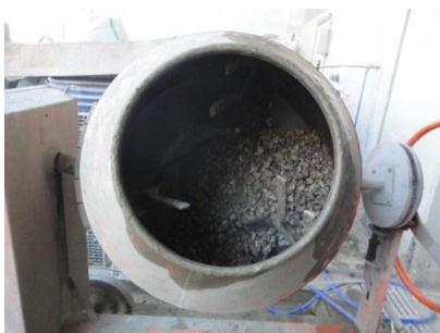
Figura 3.22 - Betoneira de eixo inclinado (primeira fase do processo de amassadura)
