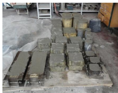
Figura 3.26 - Aspecto final após nivelamento da superfície do betão
