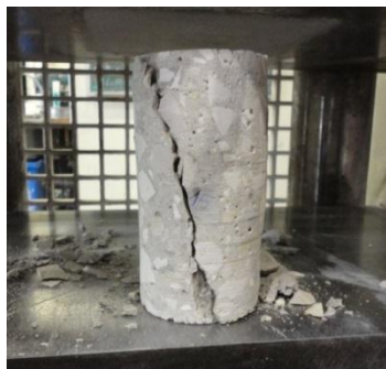
Figura 4.59 - Exemplo de rotura não satisfatória (B25 - viga)
