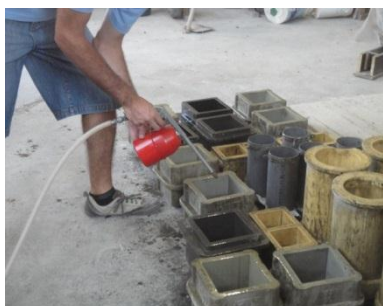
Figura 3.21 - Lubrificação dos moldes
