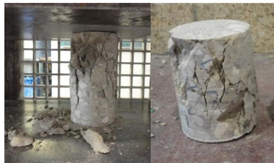
Figura 4.60 - Exemplos de roturas satisfatórias
