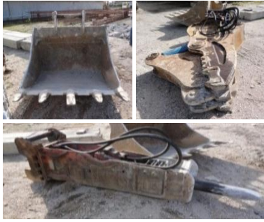
Figura 3.3 - Acessórios (balde, tesoura de maxilas e martelo pneumático)
