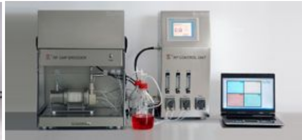
(c) Wave bioreactor (GE Healthcare Life Sciences). (d) Rotary bioreactor (Z® RP Bioreactor (Zellwerk GmbH)).
