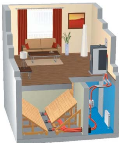
Figura 19 – Depósito de combustível isolado: sala de armazenamento de pellets [12].
