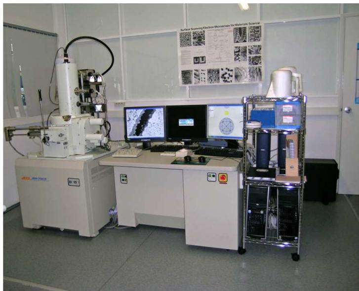
**Figura 3.2** – Microscópio electrónico de varrimento e equipamento auxiliar.
