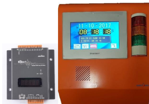
Figura 6 - Equipamento "early-warning" do "SHELTER"
