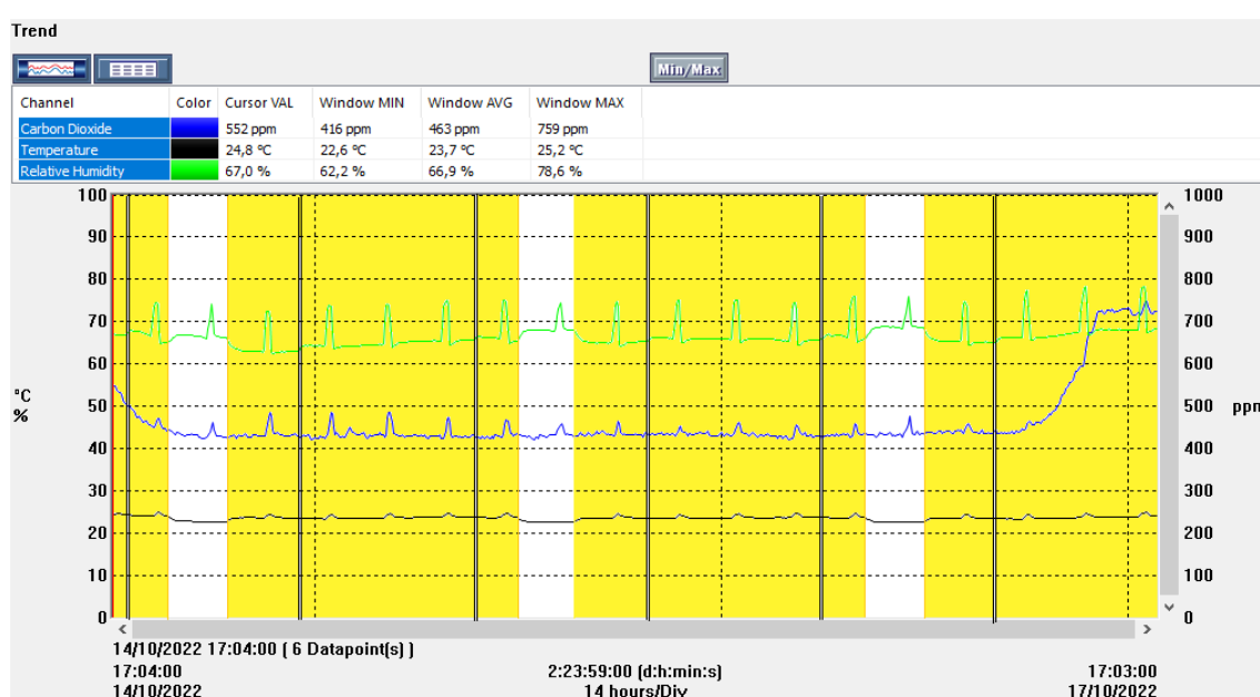
Figura 25. Variação do nível de CO 2 , T e HR dentro do módulo 2 com a ventilação ligada. A sua versão ampliada encontra-se no Anexo 8.
