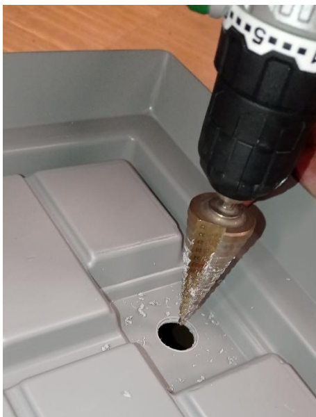
Figura 17. Furos a serem feitos nos tabuleiros para permitir a passagem da válvula e do tubo de drenagem de água.
