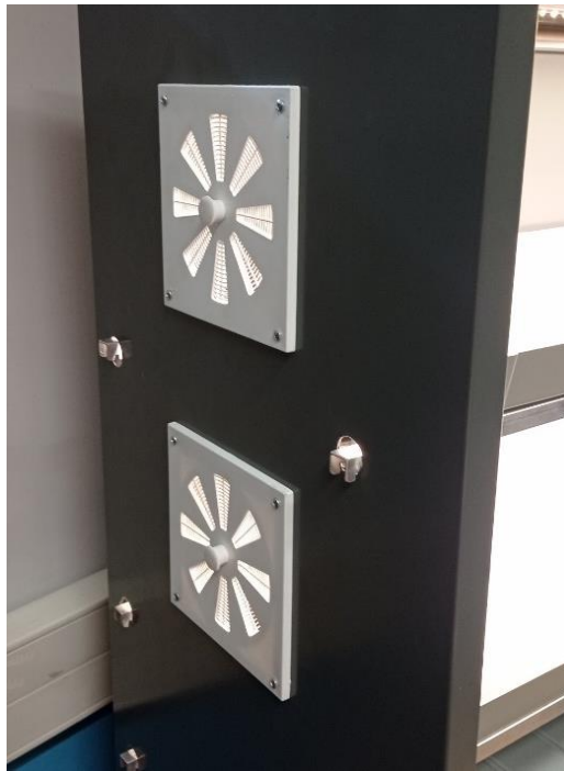
Figura 14. Grades de ventilação instaladas do lado oposto das ventoinhas.
