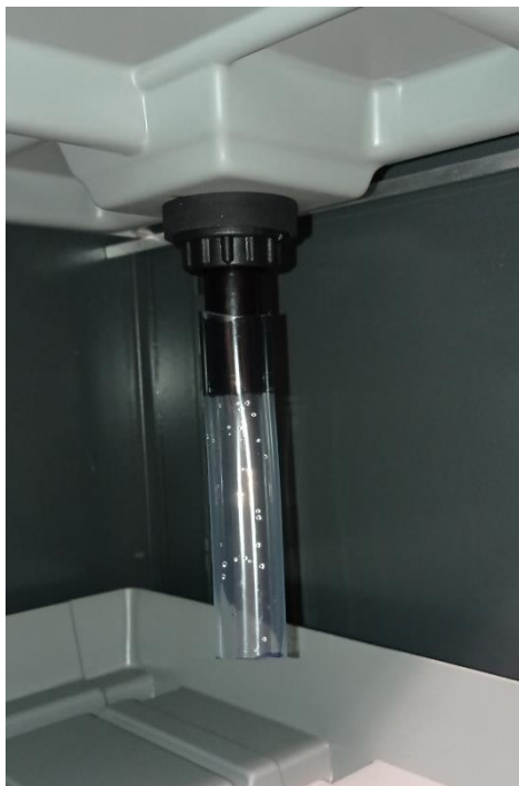
Figura 12. Detalhe do sistema de circulação de água. Interface do tudo bom a válvula de escoamento no fundo de um tabuleiro de cultivo.
