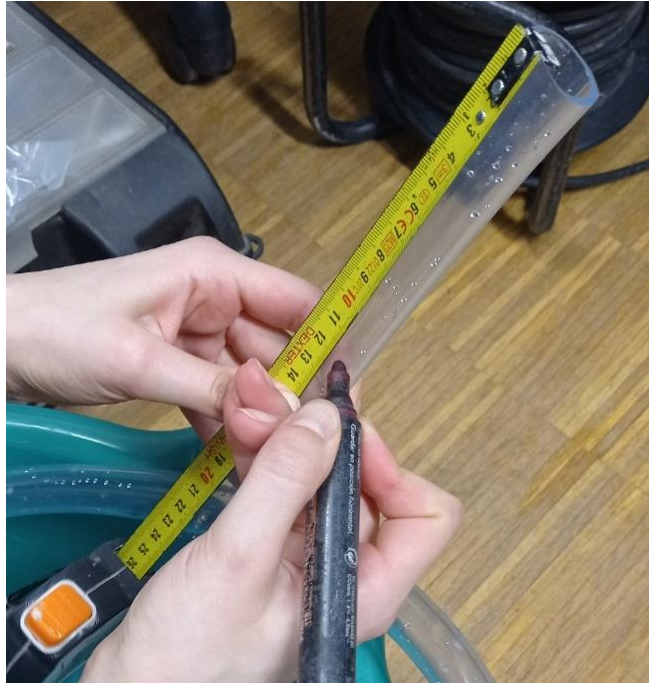
Figura 11. Processo de medida e corte da tubagem.
